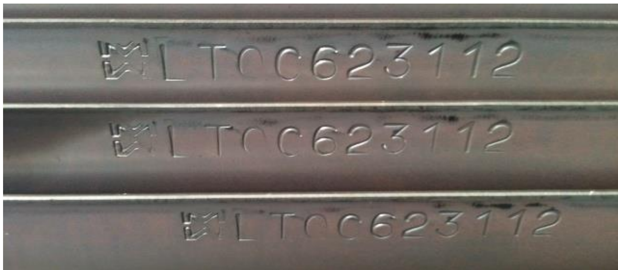
Obrázek 18 – Příklad značení (na svodnici)
